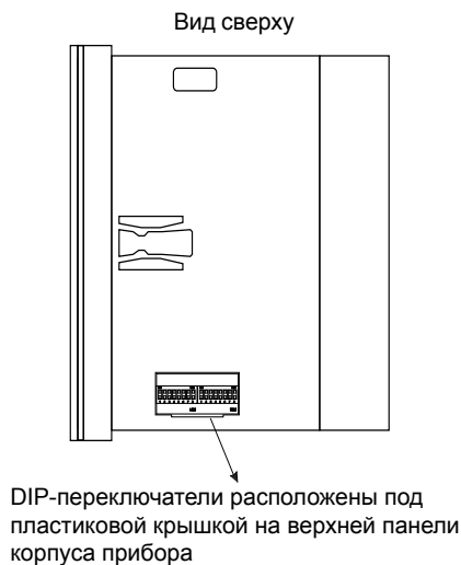
Рисунок 8.1 — расположение DIP переключателей для модулей ввода типа Е и Н
